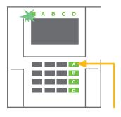
2. Appuyer sur la touche fonctionnelle pour armer une section particulière. Il est possible d'armer plusieurs sections par la suite. Le délai entre le choix des sections ne doit pas être supérieur à 2 secondes.
