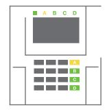
3. La commande est exécutée et la touche fonctionnelle passe au jaune en permanence pour indiquer l'armement partiel de la section.
