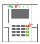
1. En entrant dans le bâtiment (déclenchement d'un détecteur avec une réaction « Zone temporisée »), le système commence à signaler la temporisation d'entrée par une tonalité continue, le voyant du système et la touche fonctionnelle, les deux clignotant
