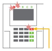
Enclencher la touche fonctionnelle de la section dans laquelle l'alarme a été déclenchée.
